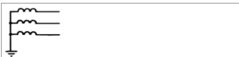
Трёхфазная сеть. Трёхпроводная с заземлённой нейтралью.
