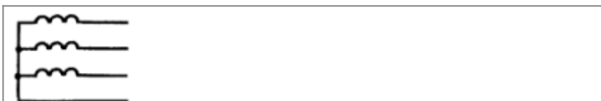
Трёхфазная сеть. Четырёхпроводная с изолированной нейтралью.
